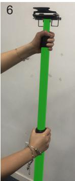
7. Ruotare il manicotto di bloccaggio superiore verso destra per allentarlo e regolare la lunghezza desiderata del tubo telescopico superiore, che si estende per un massimo di 28 cm.
