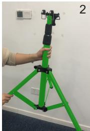
3. Tournez la poignée de verrouillage inférieure dans le sens des aiguilles d'une montre pour verrouiller les pieds en position souhaitée.
