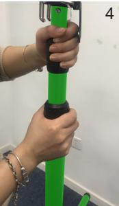
5. Ajuste el tubo telescopico medio a la longitud deseada, ajustable hasta un máximo de 32.5cm.
